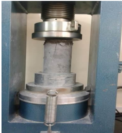
Figura 4: Corpo de prova sendo rompido. Fonte: Autores, (2018).
