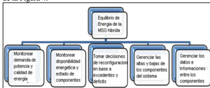
Figura 4: Funciones principales de gestión energética en una MSG.
