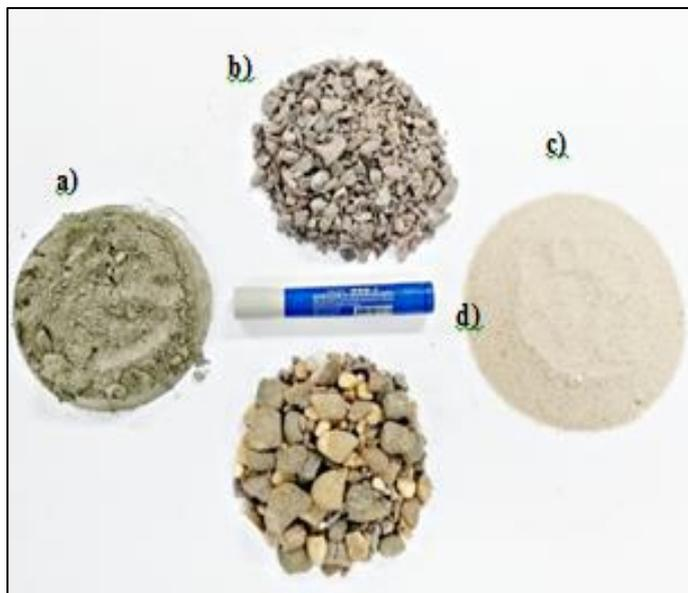
Figura 1: Agregados expostos e separados conforme a granulometria - a) Pó de brita; b) Brita 0; c) Areia; d) Seixo Rolado.
