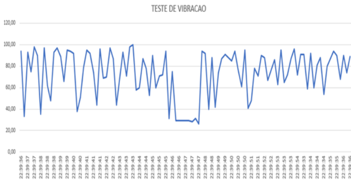
Figura12: Assinatura espectral alterada após a realização de pressão sobre o equipamento Fonte: Autores, (2018).
