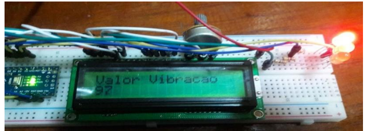
Figura 7: Níveis de vibrações dentro dos valores < 40Hz. Fonte: Autores, (2018).
