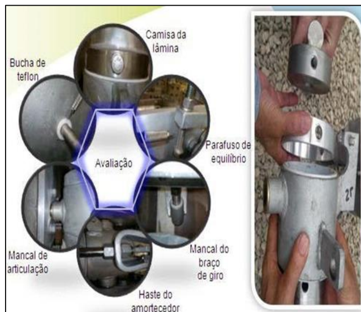
Figura 5: Fotos de uma Análise P-M em seccionador EVL 245kV- Siemens. Fonte: Autores, (2018).
