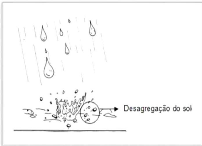
Figura 2: Processo de desagregação do solo
