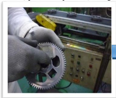
Figura 9: Processo de retirada da rebarba 100% manual.
