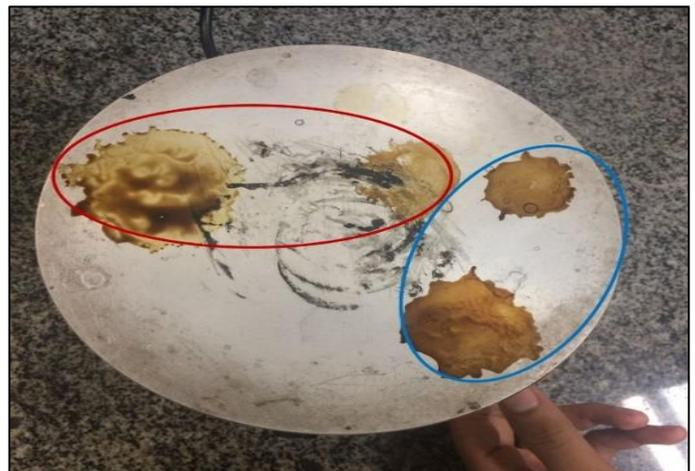
Figura 10: Amostras de óleos lubrificante sintético e semissintético analisado na chapa aquecedora.
