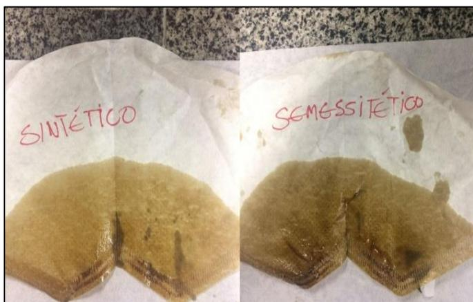
Figura 11: Amostra de óleo lubrificantes usados filtrados
