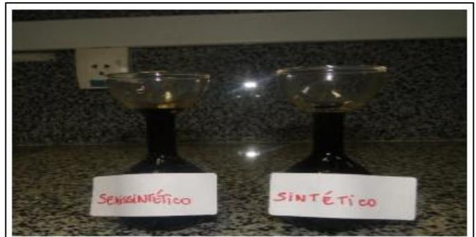
Figura 4: Amostras de óleos lubrificantes usados. Fonte: Autores, (2016).
