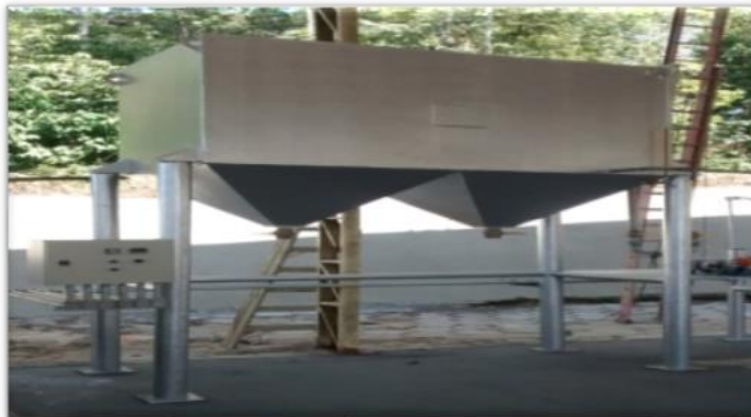
Figura 2 - Tanque Reservatório de Alimentação da matéria-prima Fonte: Autores, (2015).
