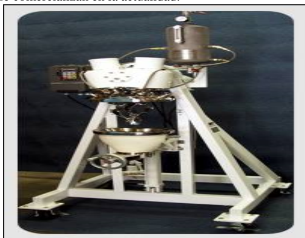
Figura 3: Reactor químico cónico vertical 4 pulgadas y mezclador en forma de cuchillas helicoidal cónico.
