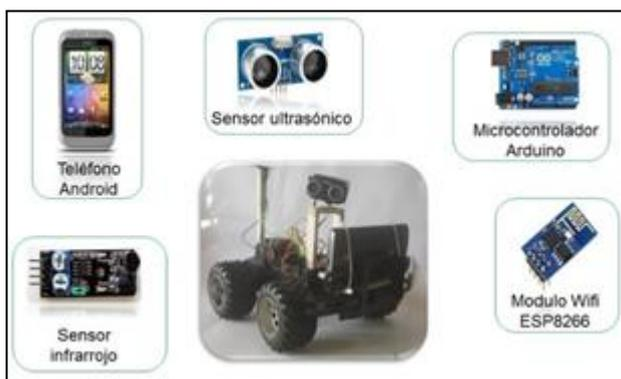
Figura 3: Plataforma robótica móvil.
