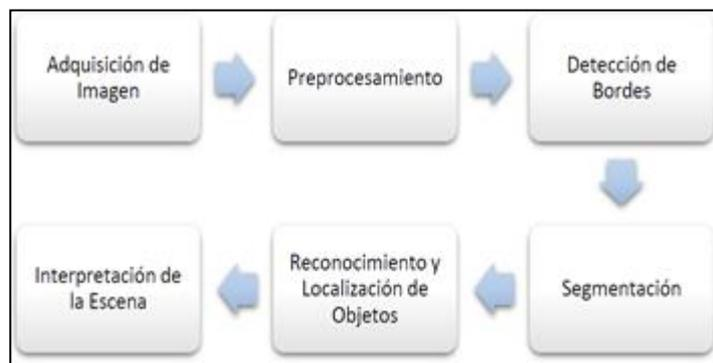
Figura 2: Etapas de un Sistema de Visión por Computador.
