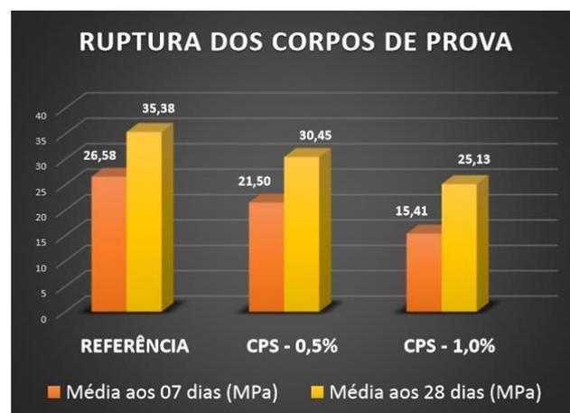
Figura 10: Gráfico de ruptura dos corpos de prova em MPa aos 07 e 28 dias de cura úmida do concreto endurecido.
