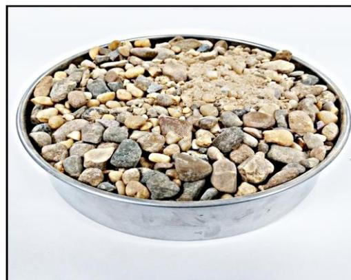
Figura 6: Recipiente utilizado para análise da massa unitária dos agregados miúdo e graúdo.
