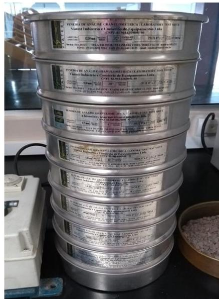
Figura 5: Peneiras utilizadas para o ensaio de caracterização dos agregados miúdo e graúdo.
