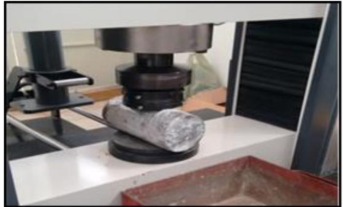
Figura 3: Tração por compressão diametral.
