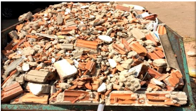
Figura 2: Resíduos de construção e demolição (RCD) coletados. Fonte: Autores, (2018).
