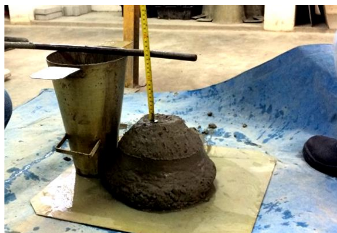
Figura 7: Altura média da amostra assentada ( Slump test ). Fonte: Autores, (2018).
