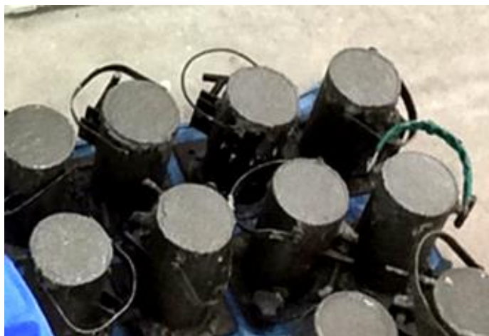
Figura 9: Moldagem dos corpos de prova. Fonte: Autores, (2018).
