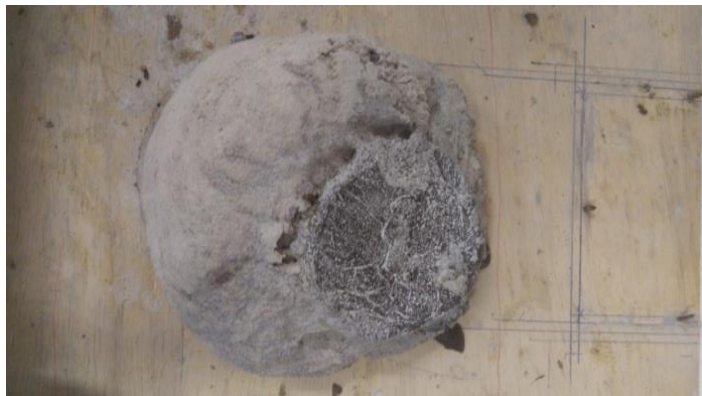
Figura 10: Corpo de prova que não ocorreu a pega. Fonte: Autores, (2018).
