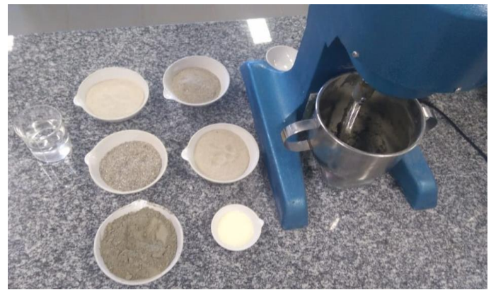
Figura 7: Materiais e equipamento de mistura da argamassa. Fonte: Autores, (2018).
