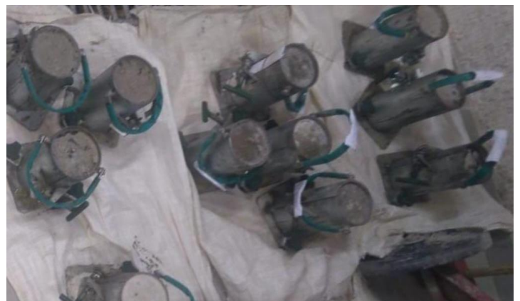
Figura 4: Corpos de prova em forma. Fonte: Autores, (2018).
