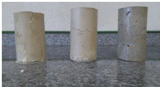
Figura 11: Cp's com concentrações diferentes de açúcar. Fonte: Autores, (2018).
