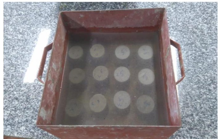
Figura 8: Corpos de prova imersos. Fonte: Autores, (2018).
