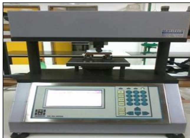
Figura 3: Flexímetro utilizado para ensaios de tensão de ruptura e flexão nos corpos de prova.
