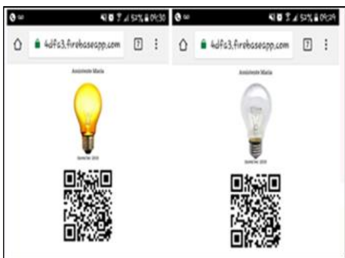
Figura 8: Interface Touch screen da maria assistente para ligar ou desligar uma lâmpada. Fonte: Autores (2018).
