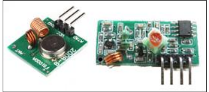
Figura 2: Módulo RF Transmissor e Receptor de 433 MHz. Fonte: [6].
