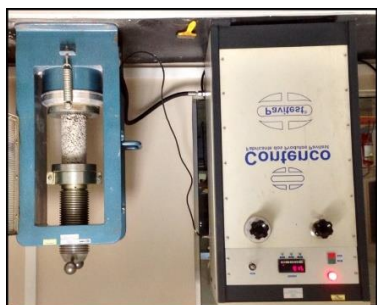
Figura 6: Momento do processo de ruptura do corpo de prova na prensa elétrica I3025-B.
