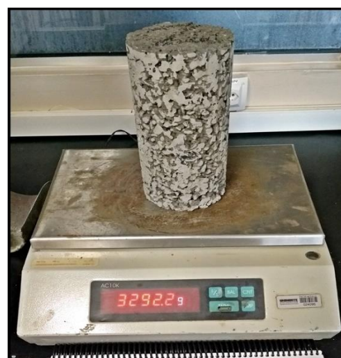
Figura 8: Corpo de prova desenhado e pesado antes de ser levado ao teste de ruptura.
