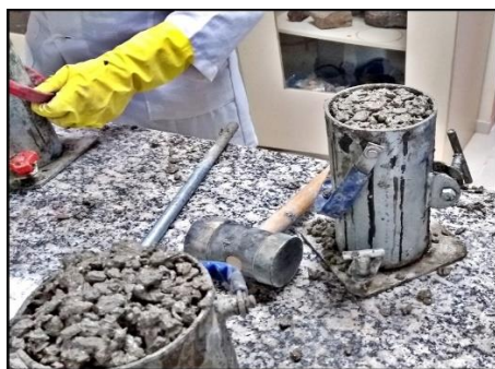
Figura 4: Processo de moldagem dos corpos de prova após a mistura dos materiais já citados a cima.
