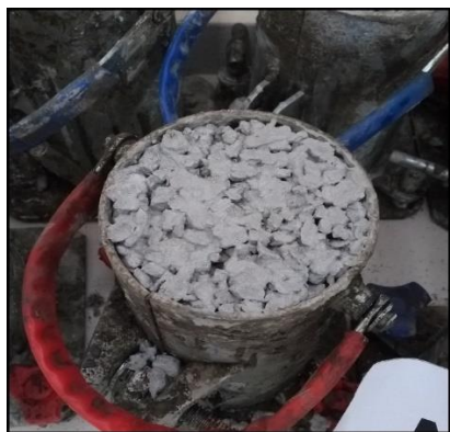
Figura 5: Foto aproximada de um corpo de prova após sete dias de cura ambiente
