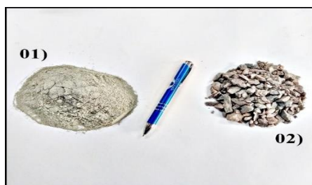
Figura 1: Agregados utilizados para a confecção do concreto permeável – 01) Cimento CP II Z-32, MIZU Super Forte; 02) Brita Zero.
