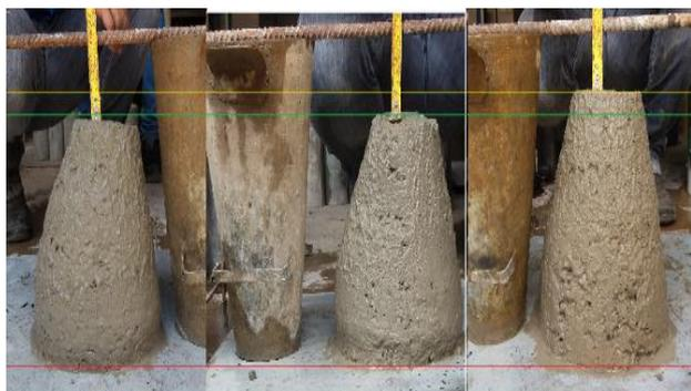
Figura 4 - Ensaio de abatimento.
