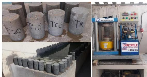
Figura 3 - Ensaio de compressão.
