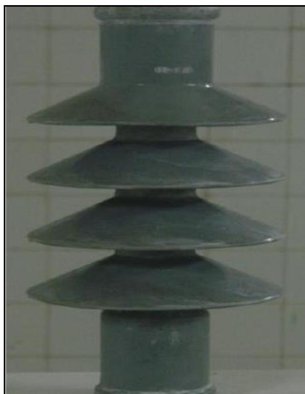
Figura 1: Aislador ensayado.
