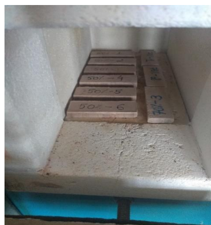
Figura 3: Material pronto para a queima a 950°C na Mufla.
