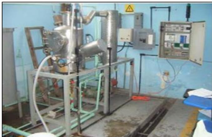
Figura 1: Cristalizador-Evaporador.
