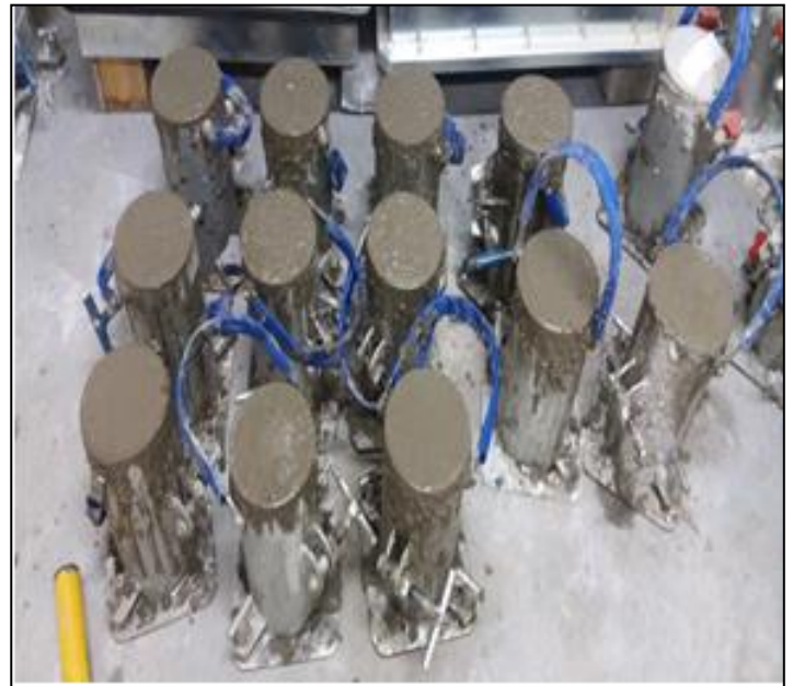
Figura 5: Moldagem dos corpos de prova.
