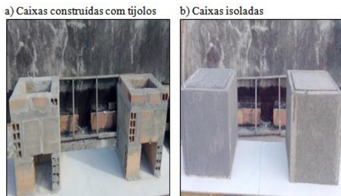
Figura 4: Processo construtivo das caixas com raspas de pneus. Fonte: Autores, (2017).
