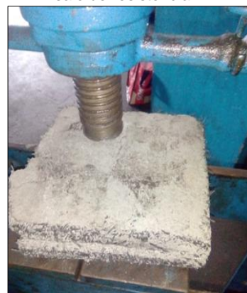
Figura 5: Demonstração dos ensaios com as placas de isolamentos térmicos e acústicos.
