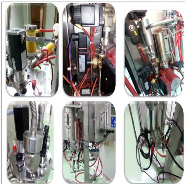
Figura 6: Montaje de sensores/transmisores y actuadores. Fuente: autores, 2017.
