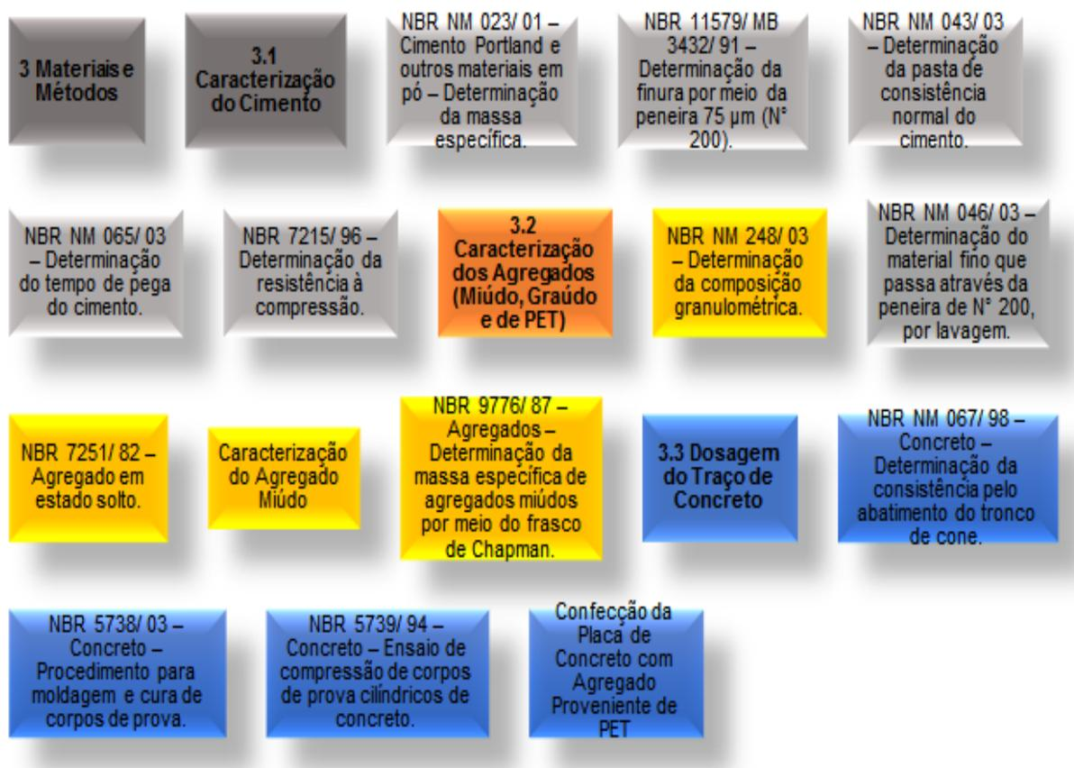
Figura 4: Fluxograma dos materiais e métodos a serem utilizados.
