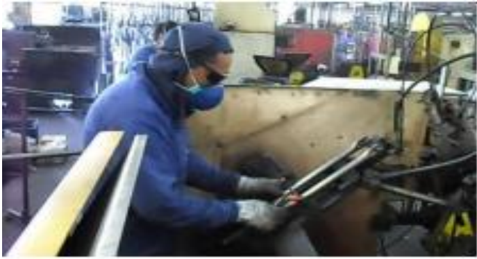
Figura 6: Fechando à alavanca que trava as peças no gabarito de solda.
