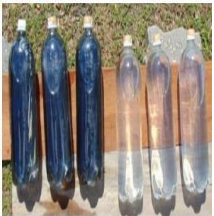
Figura 1: Experimentos de desinfecção solar de água de chuva: superfície de metal na imagem da esquerda e superfície de madeira na imagem da direita.
