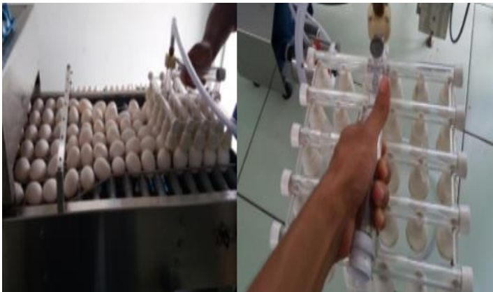
Figura 6: Introdução do ovo no processo (sugador). Fonte: Autores, (2016).
