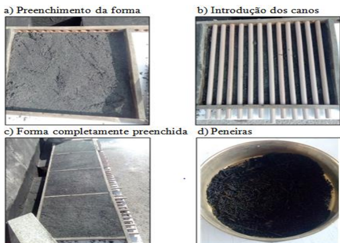
Figura 2: Demonstração do 1º teste na construção das placas. Fonte: Autores, (2017).
