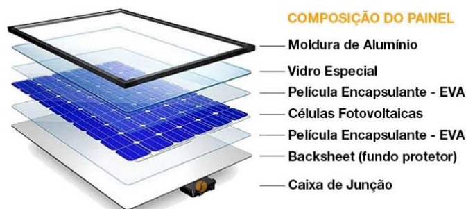
Figura 8 - Composição Básica do Painel Fotovoltaico. Fonte: [49].
