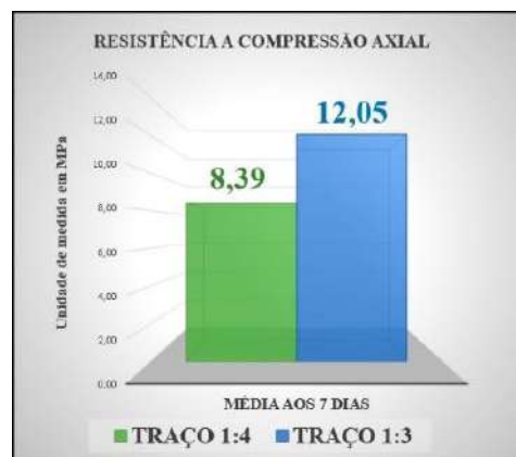
Figura 9: Gráfico da resistência média à compressão em MPa de cada traço confeccionado e rompido aos 7 dias.
