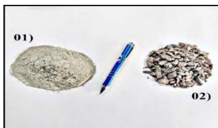
Figura 1: Agregados utilizados para a confecção do concreto permeável – 01) Cimento CP II Z-32, MIZU Super Forte; 02) Brita Zero.
