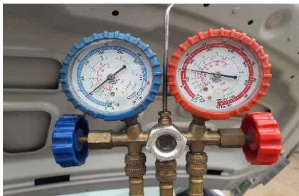
Figura 6: Monômetro Analógico de refrigeração após a implantação do sistema auxiliar.
