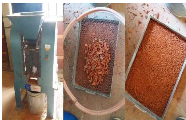
Figura 1 - Tratamento do resíduo cerâmico. Fonte: Autores, (2019).
