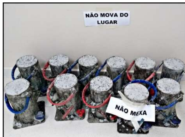
Figura 7: Corpos de prova endurecidos após sete dias moldados no tamanho 10/20 centímetros seguindo as especificações.
