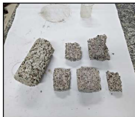
Figura 10: Corpos de prova expostos após o teste de ruptura aos sete dias
