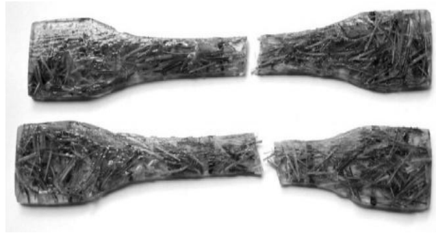
Figura 8: Aspecto da fratura do material compósito de poliéster reforçado por fibras de licuri de 10 mm de comprimento.
