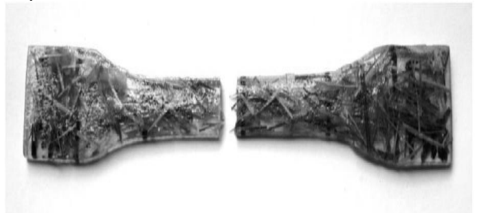
Figura 9: Aspecto da fratura do material compósito de poliéster reforçado por fibras de licuri de 15mm de comprimento.
