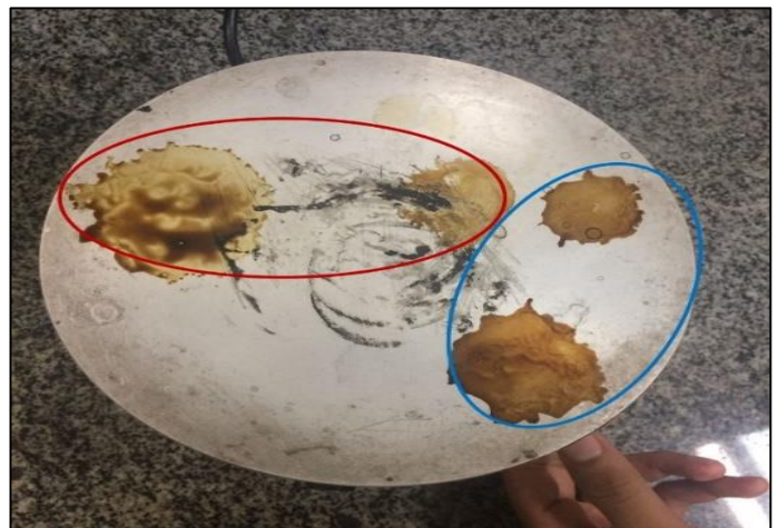
Figura 10: Amostras de óleos lubrificante sintético e semissintético analisado na chapa aquecedora. Fonte: Autores, (2016).
